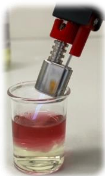
Gold-Nanopartikel Synthese mit Hilfe eines Flambierers - nach Heinzerling & Oetken 2018 [9].
