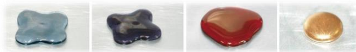
Reaktionsverlauf der Gold-Nanopartikel Synthese im Leidenfrost-Reaktor (von links nach rechts) - aus Schwarzer et al. 2016 [10].
