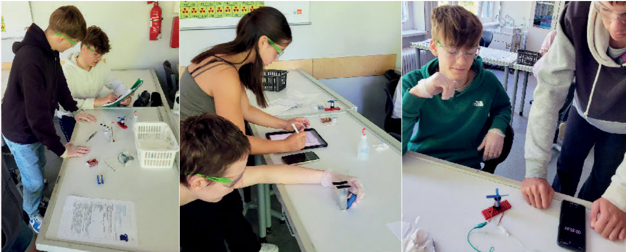
Schüler:innen experimentieren mit elektrochemischen Zellen in einer Tic-Tac-Box; links bauen sie die Elektrolysezelle zusammen, in der Mitte elektrolysieren sie Wasser, und rechts messen sie, wie lange der Propellermotor mit einer geladenen Brennstoffzelle läuft.
